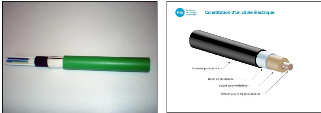
Figure 45 : câble optique (à gauche) et principe de constitution d'un câble à isolation synthétique (à droite)
