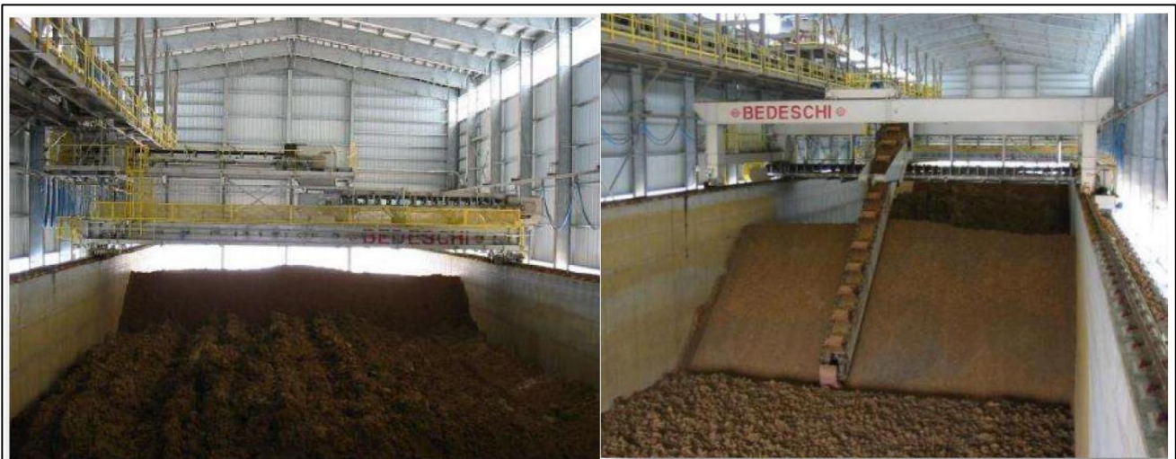
Figure 11 : Vues des unités d'empilage et de récupération
